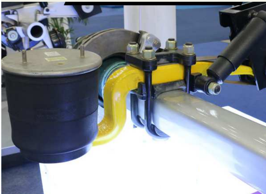
这款是美式正装空气悬架，导向臂采用钢板焊接而成，质量轻但是承载能力相比欧式要差。
